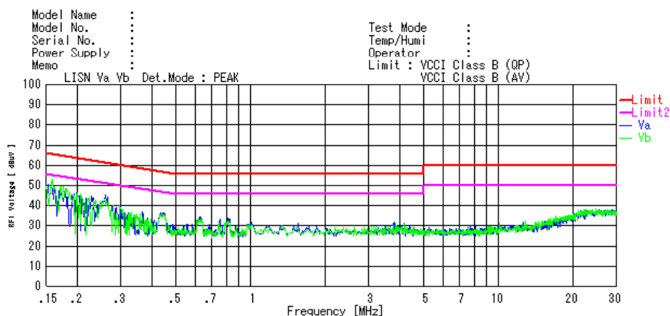
図19 雑音端子電圧波形 参考データ Fig.19 Conduction Noise Waveform Reference data
