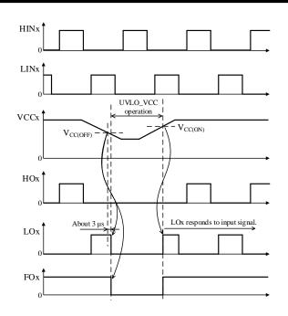
Figure 12-14. UVLO\_VCC Operational Waveforms
