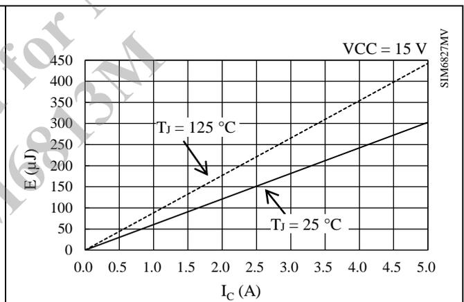
図 15-50 ローサイドスイッチング損失特性
