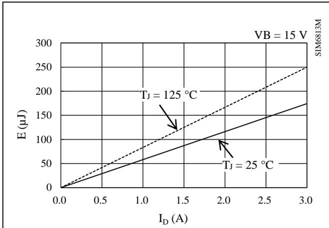
図 15-43 ハイサイドスイッチング損失特性
