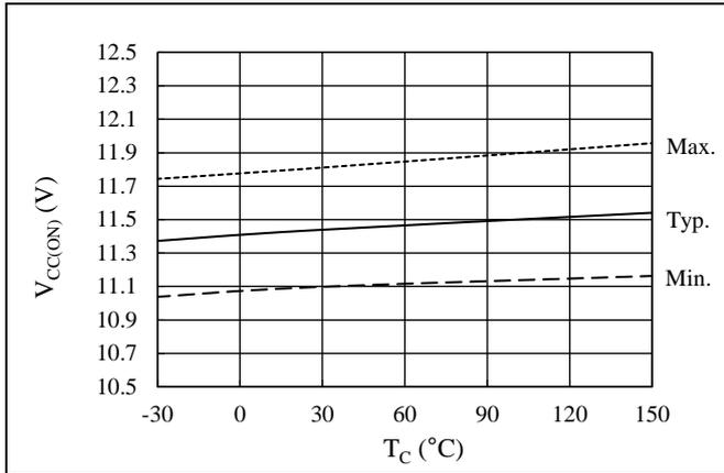
図 15-12 制御動作開始電圧 V<sub>CC(ON)</sub>温度特性
