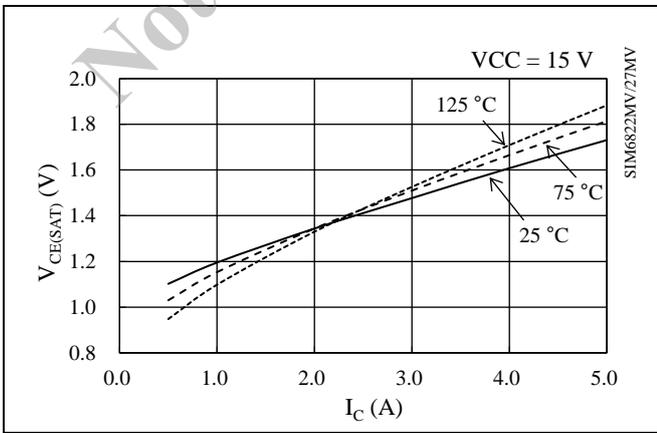
図 15-37 IGBT  $V_{CE(SAT)} - I_C$  特性
