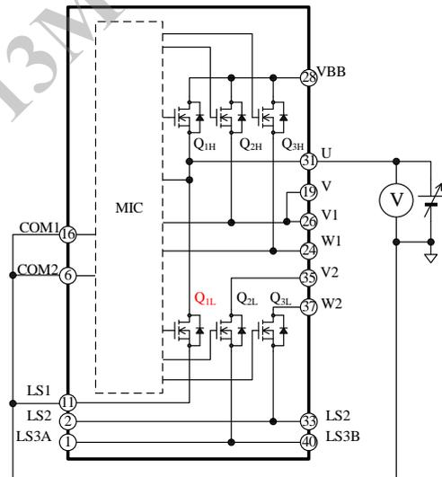
図 13-4 U 相ローサイド素子(Q<sub>IL</sub>)耐圧測定回路
