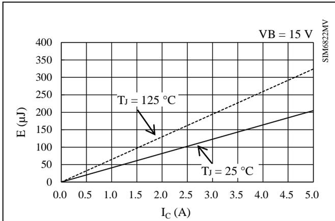
図 15-47 ハイサイドスイッチング損失特性
