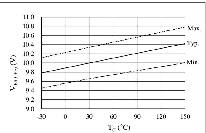
図 15-11 制御動作停止電圧  $V_{BS(OFF)}$  温度特性
