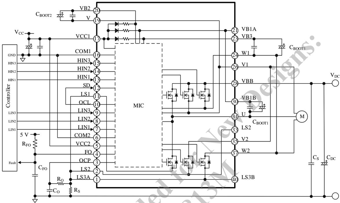
図 9-1 応用回路例 (SIM6810M、1 シャント検出方式)
