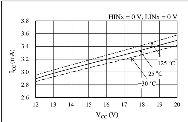
図 15-6 VCCx 端子電圧  $V_{CC}$  - 制御電源電流  $I_{CC}$  特性
