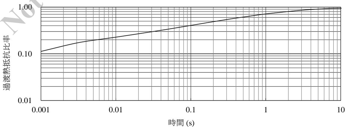
図 15-3 SIM6880M 過渡熱抵抗比率
