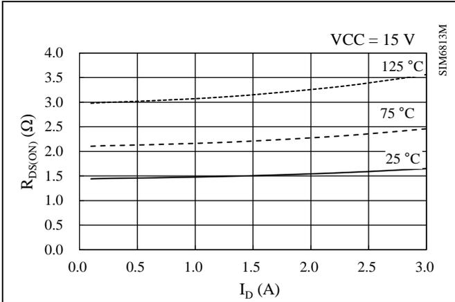
図 15-33 パワーMOSFET  $R_{DS(ON)} - I_D$  特性
