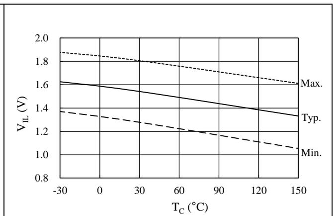
図 15-17 ローレベル入力しきい電圧 V<sub>tl</sub>温度特性
