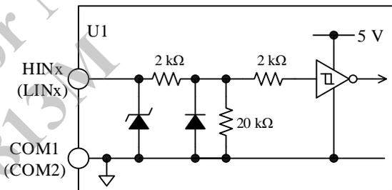
図 12-6 HIN<sub>x</sub> 端子、LIN<sub>x</sub> 端子の内部回路図
