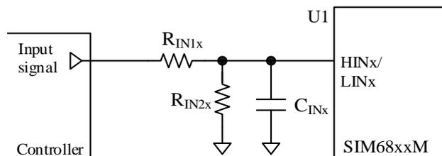
図 12-7 HIN<sub>x</sub> 端子、LIN<sub>x</sub> 端子のフィルタ回路
