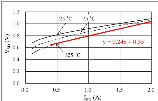
図 14-3  $V_{SD}$ - $I_{SD}$  特性の 1 次近似式
