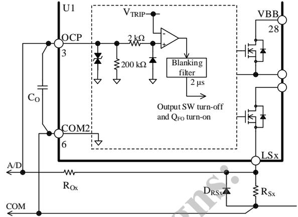
図 12-14 OCP 端子の周辺回路と内部回路図
