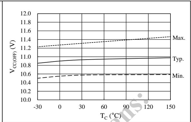
図 15-13 制御動作停止電圧 V<sub>CC(OFF)</sub>温度特性
