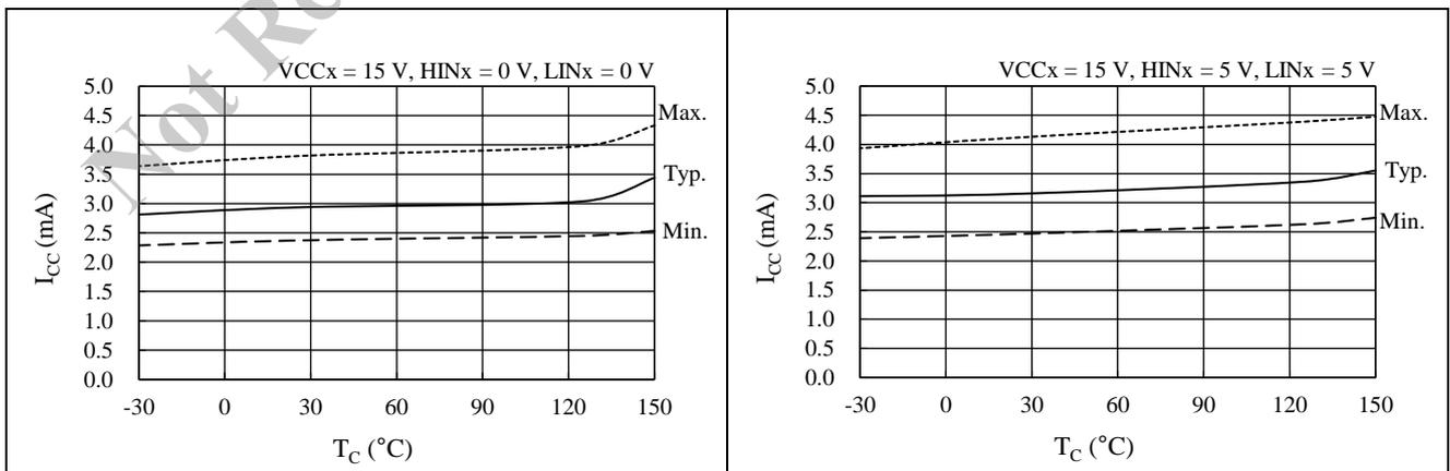
図 15-4 制御電源電流 I<sub>CC</sub> 温度特性 (I<sub>Nx</sub> = 0 V)
