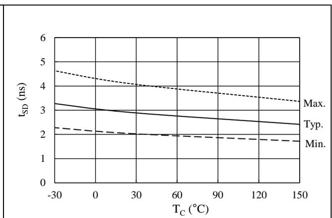
図 15-23 SD 端子フィルタ時間温度特性
