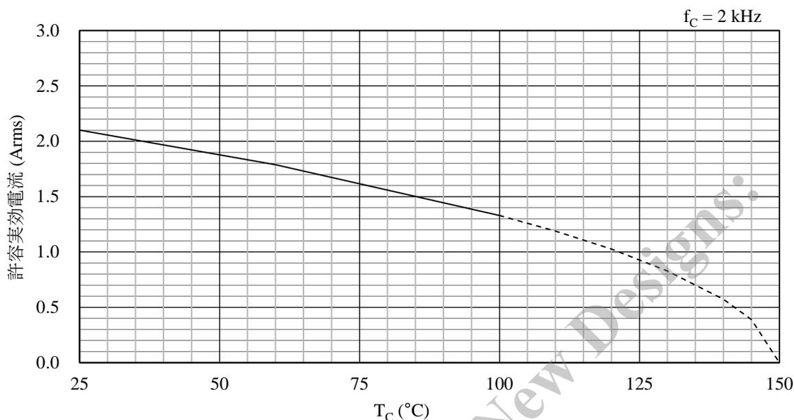
図 15-55 SIM6813M 許容電流特性 ( $f_c = 2 \text{ kHz}$ )
