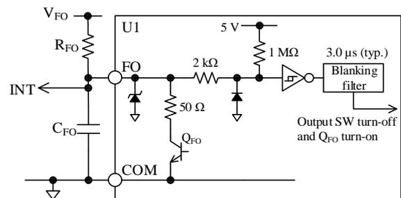
図 12-9 FO 端子の周辺回路と内部回路
