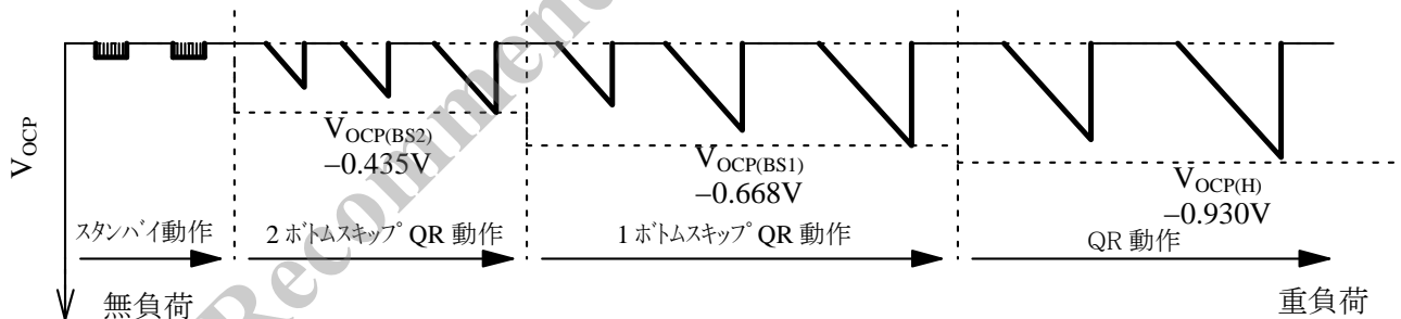
図 7-19 無負荷→重負荷時の状態遷移図
