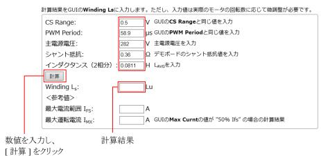
図 2-2 Winding Ls 計算ツール
