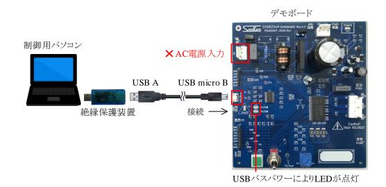
図 2-3 USB ケーブルでの接続
