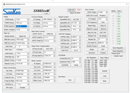
制御用パソコンと IC が通信できる状態になると、 [USB-I2C] 表示が「FAIL!」から「OKAY!」に切り換わります。
