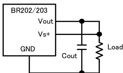
出力センス端子を出力電圧ラインに接続するとき、LC フィルタの出力に接続しないでください。正常に動作しない可能性があります。
