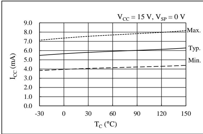
図 14-3 制御電源電流  $I_{CC}$  温度特性
