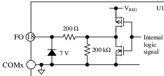
図 11-8 FO 端子の内部回路図
