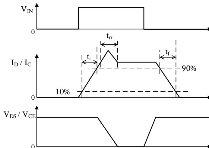
図 3-1 スイッチング時間の定義
