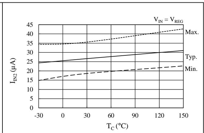
図 14-14 ハイレベル入力電流 2 温度特性 (OCP 端子)
