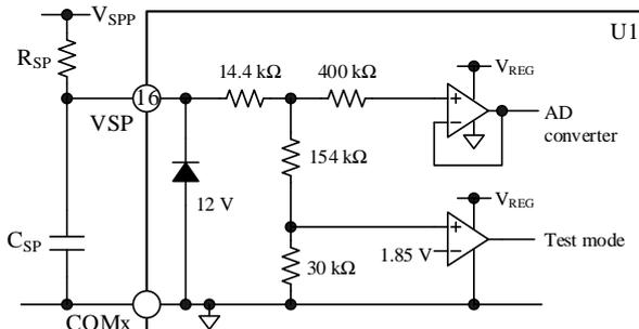
図 11-12 VSP 端子の周辺回路と内部回路図
