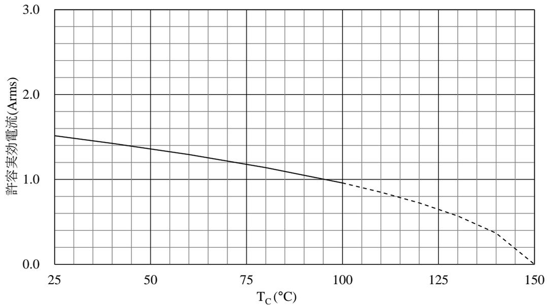
図 14-28 SIM2601M 許容電流特性 ( $f_C = 17 \text{ kHz}$ )
