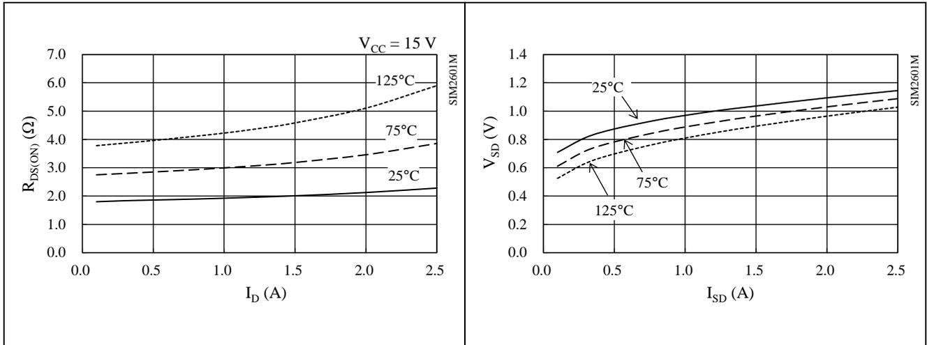
図 14-20 パワーMOSFET  $R_{DS(ON)}$  -  $I_D$  特性
