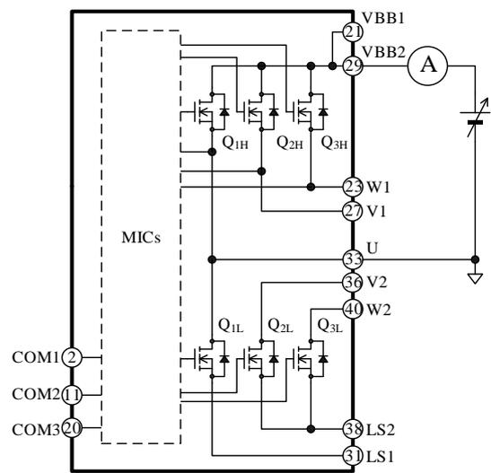
図 12-2 U 相ハイサイド出力素子 (Q<sub>IH</sub>) リーク電流測定回路
