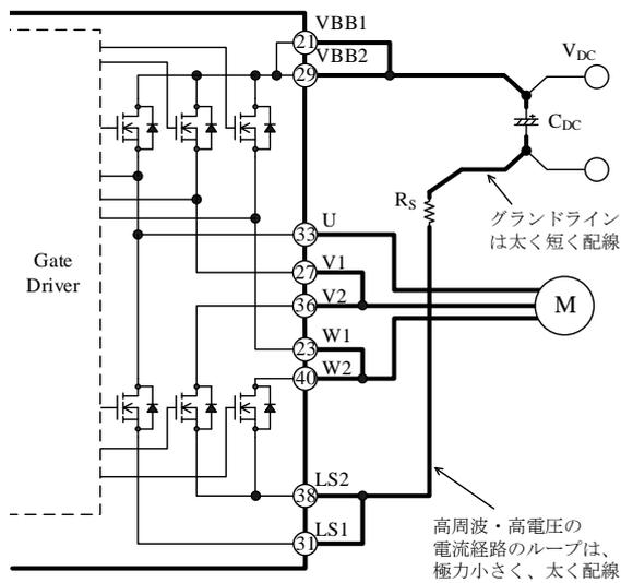
図 12-1 高周波かつ高電圧の電流経路
