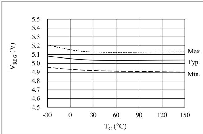
図 14-15 VREG 端子電圧 V<sub>REG</sub> 温度特性
