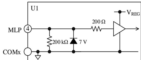
図 11-2 MLP 端子の内部回路図
