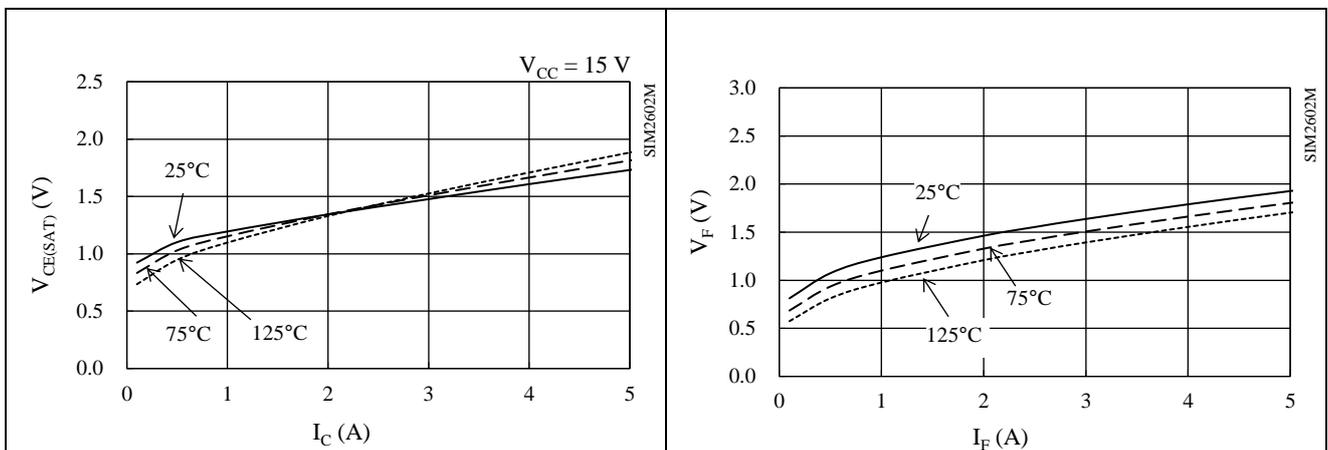
図 14-22 IGBT  $V_{CE(SAT)}$  -  $I_C$  特性
