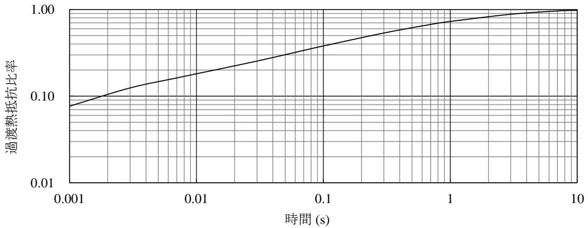
図 14-2 SIM2602M 過渡熱抵抗比率
