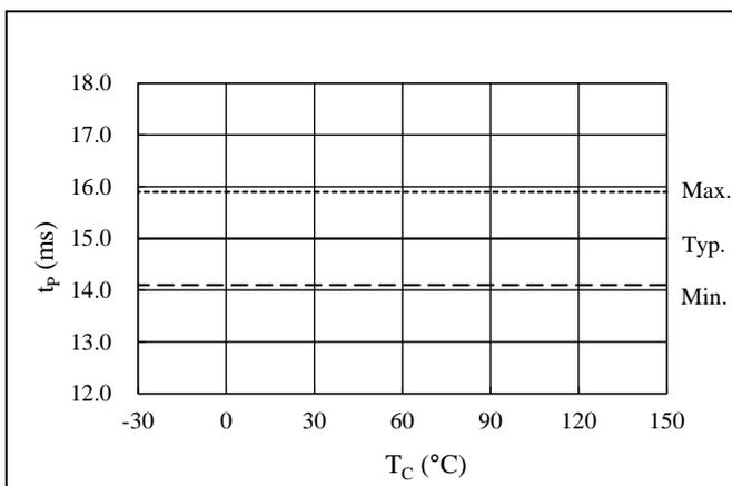
図 14-19 過電流保護保持時間 t<sub>p</sub> 温度特性
