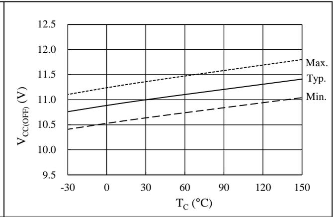
図 14-10 ローサイド制御動作停止電圧  $V_{CC(OFF)}$  温度特性
