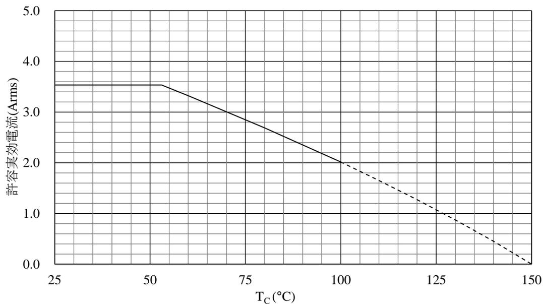
図 14-29 SIM2602M 許容電流特性 (f<sub>c</sub> = 17 kHz)
