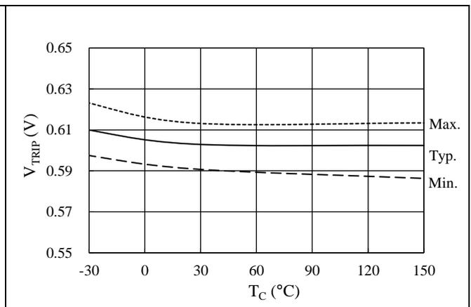
図 14-18 過電流保護動作電圧 V<sub>TRIP</sub> 温度特性
