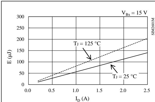
図 14-24 ハイサイドスイッチング損失特性
