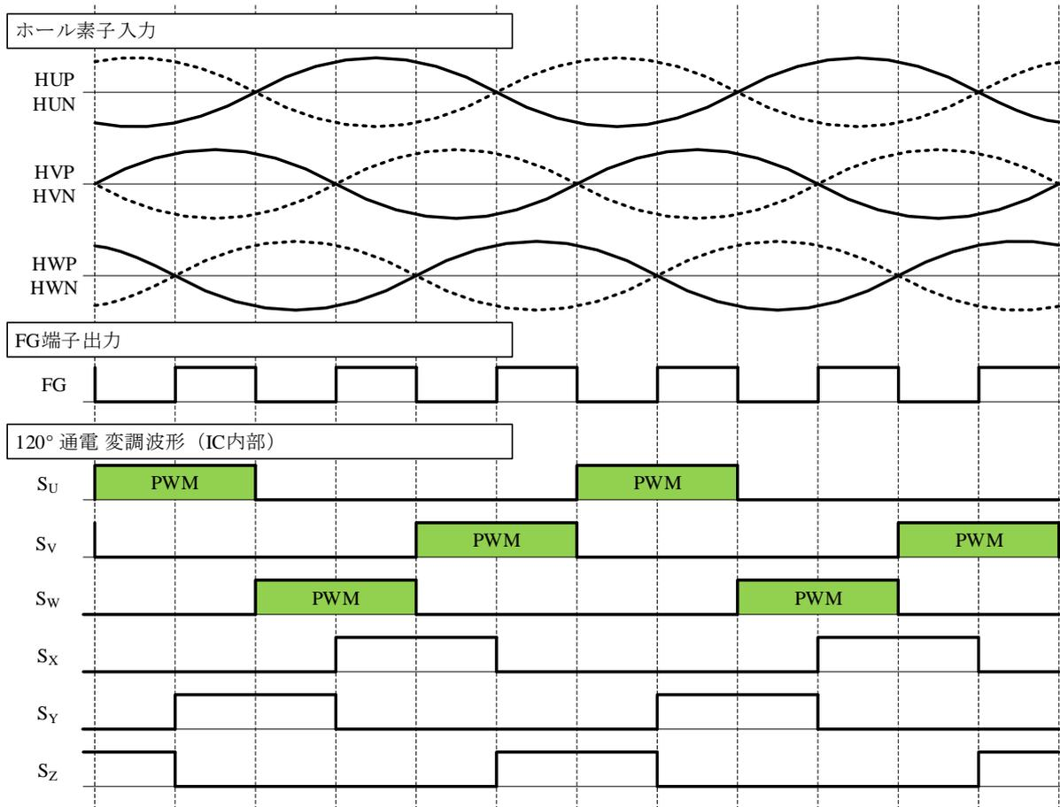
図 11-17 動作波形（反時計回り）
