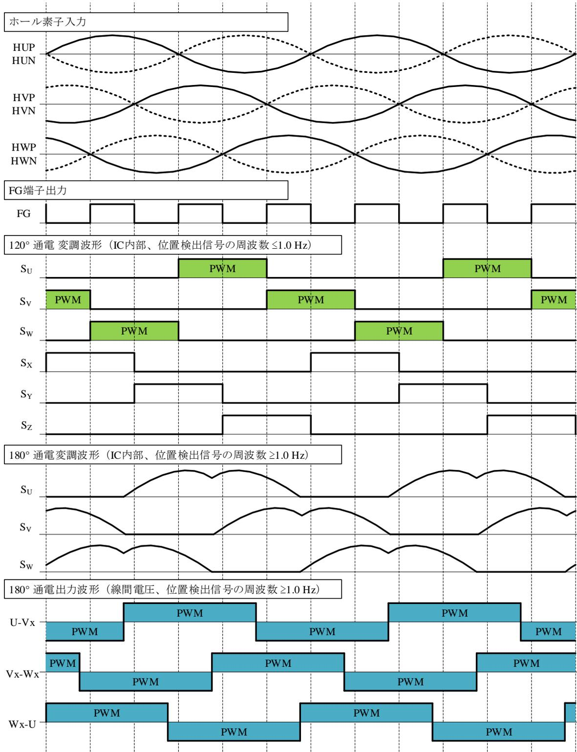
図 11-16 動作波形（時計回り、進角  $15^\circ$ ）
