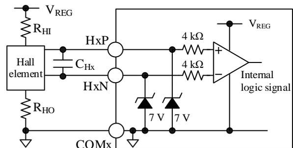
図 11-6 HxP 端子、HxN 端子の内部回路
