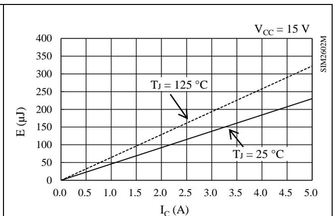
図 14-27 ローサイドスイッチング損失特性
