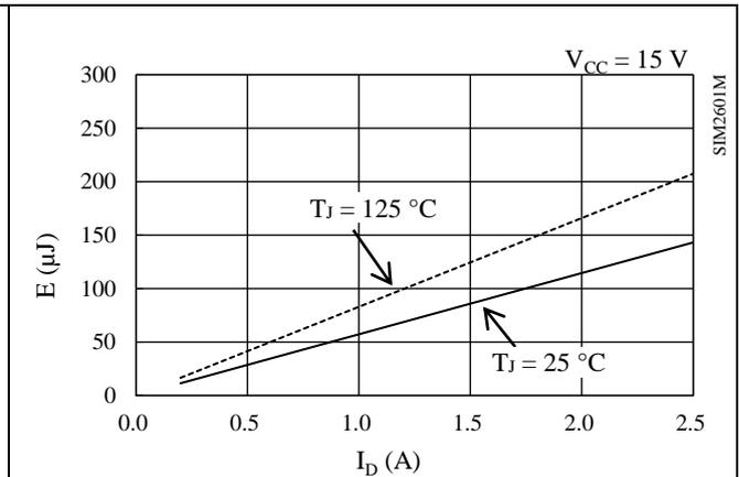
図 14-25 ローサイドスイッチング損失特性
