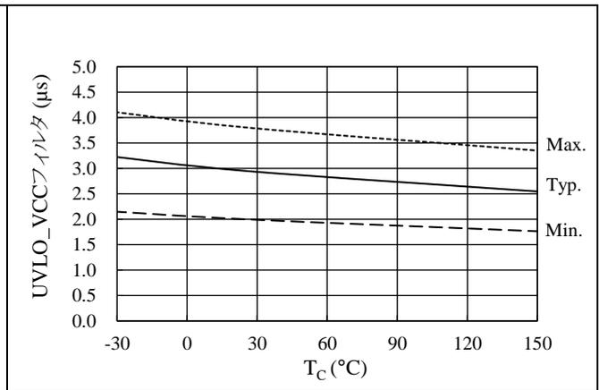
図 14-12 UVLO\_VCC フィルタ時間温度特性
