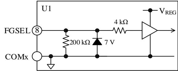
図 11-5 FGSEL 端子の内部回路図
