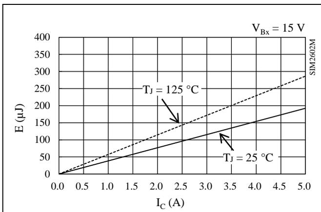
図 14-26 ハイサイドスイッチング損失特性
