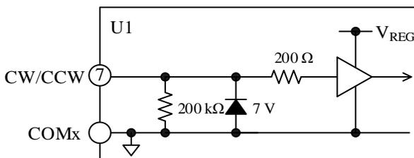
図 11-4 CW/CCW 端子の内部回路図
