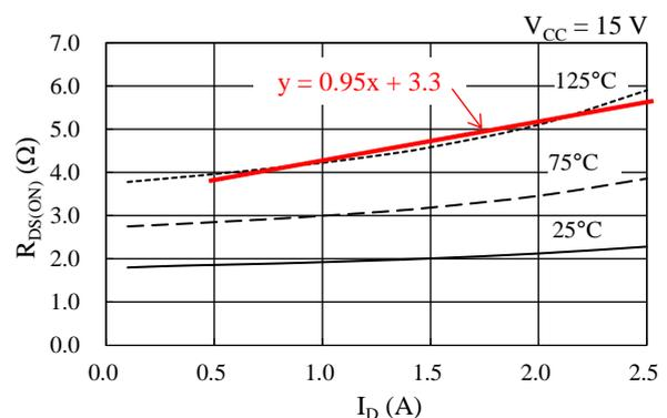
図 13-1  $R_{DS(ON)}-I_D$  特性の 1 次近似式
