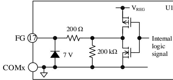
図 11-7 FG 端子の内部回路図
