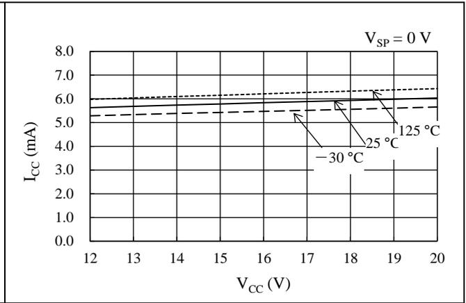
図 14-4  $V_{CC}$  端子電圧  $V_{CC}$  - 制御電源電流  $I_{CC}$  特性
