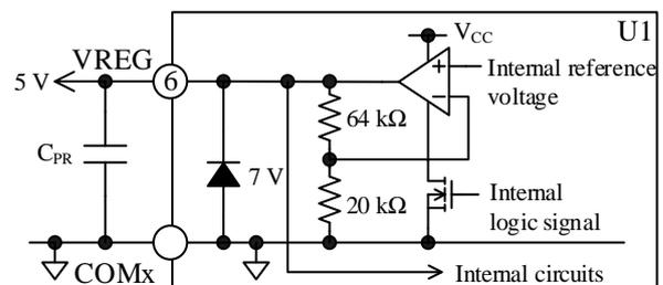
図 11-3 VREG 端子の内部回路図
