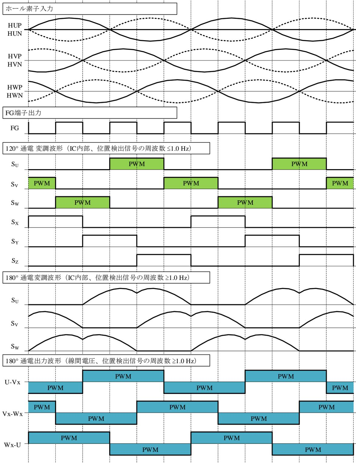
図 11-15 動作波形 (時計回り、進角なし)
