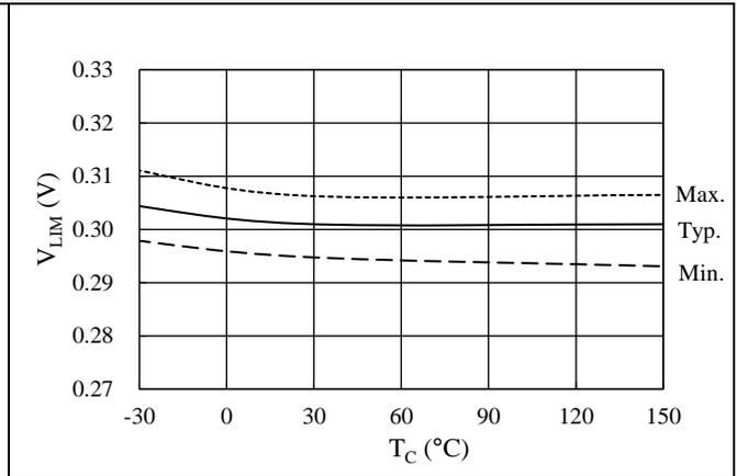
図 14-16 電流リミッタ基準電圧 V<sub>LIM</sub> 温度特性
