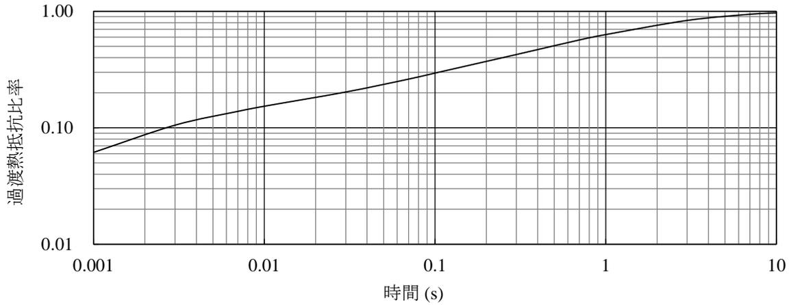
図 14-1 SIM2601M 過渡熱抵抗比率
