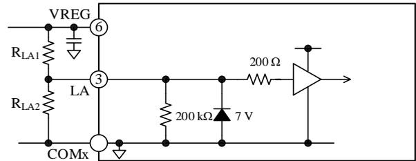
図 11-13 LA 端子の内部回路図
