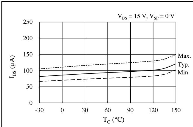
図 14-5 制御電源電流 (1 相)  $I_{BS}$  温度特性 ( $V_{SP} = 0\text{ V}$ )
