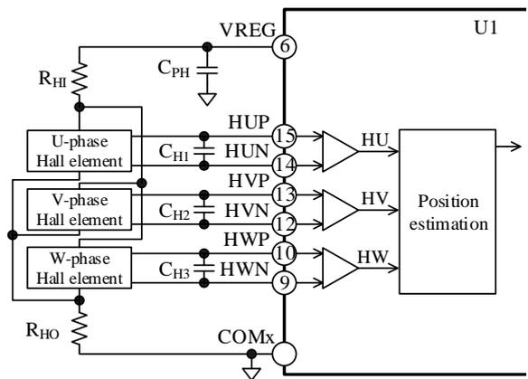
図 11-19 HxP 端子と HxN 端子の内部回路と周辺回路
