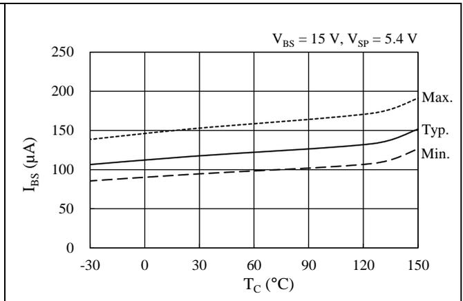
図 14-6 制御電源電流 (1 相)  $I_{BS}$  温度特性 ( $V_{SP} = 5.5\text{ V}$ )
