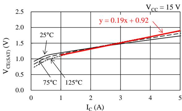
図 13-3  $V_{CE(SAT)} - I_C$  特性の 1 次近似式
