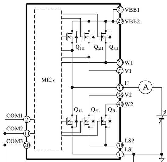
図 12-3 U 相ローサイド出力素子 (Q<sub>IL</sub>) リーク電流測定回路
