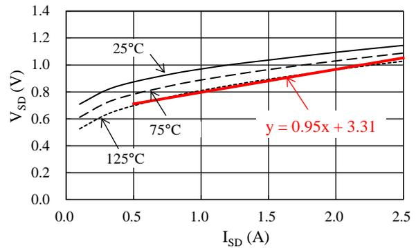
図 13-2  $V_{SD}-I_{SD}$  特性の 1 次近似式
