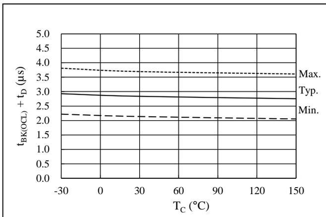
図 14-17 電流リミッタブランキング時間 t<sub>BK(OCL)</sub> + 内部遅延時間 t<sub>D</sub> 温度特性
