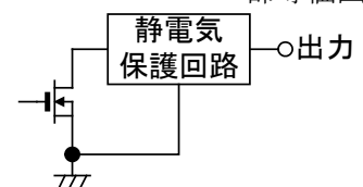
図 13-6 モニター出力端子内部等価回路
