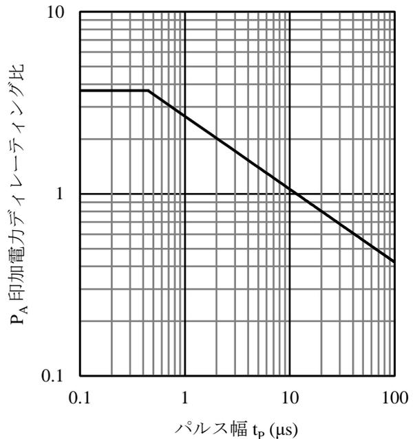
図6  $P_A$ 印加電力ディレーティング比- $t_p^{(2)}$ 特性
