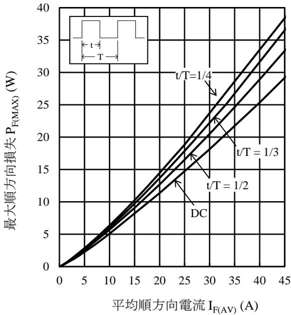
図7  $P_{F(MAX)} - I_{F(AV)}$ 特性 ( $T_j = 150^\circ\text{C}$ )
