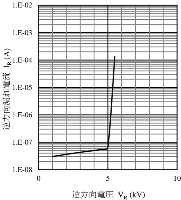
図4  $I_R - V_R$  代表特性 ( $T_J = 25\text{ }^\circ\text{C}$ )
