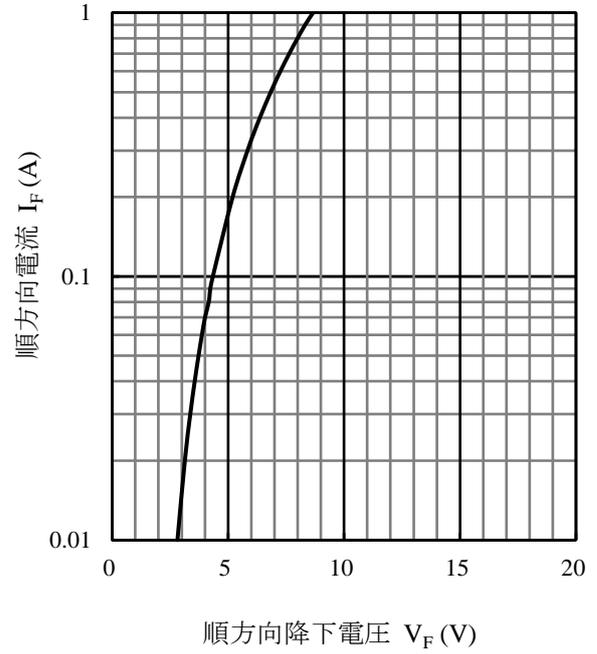
図3  $I_F - V_F$  代表特性 ( $T_J = 25\text{ }^\circ\text{C}$ )
